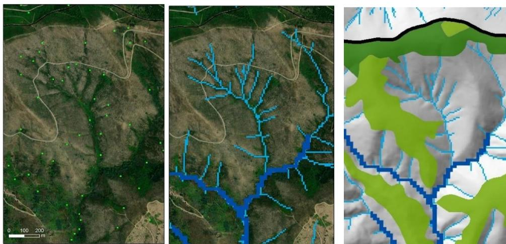
Figura 6 – Pontos de início das linhas de água, linhas de água gerada com bacia de drenagem com área 0,05 km<sup>2</sup> e cabeceiras das linhas de água (verde)
