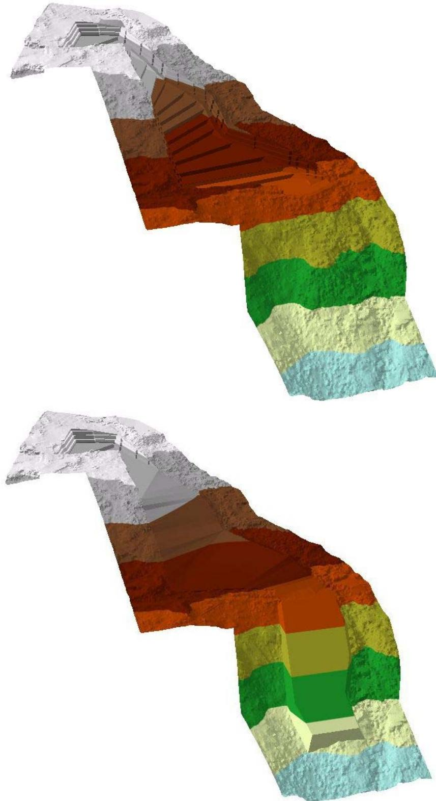
Figura 6 - Esquema da topografia com as cotas mínimas de exploração (em cima) e após a regularização topográfica (em baixo).
