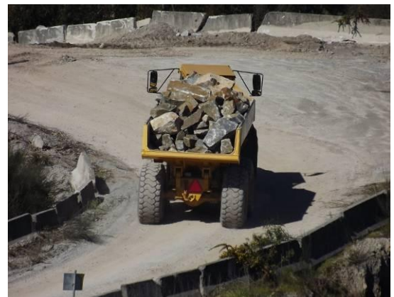
Fotografia 4 - Transporte do granito para a instalação de britagem e beneficiação.
