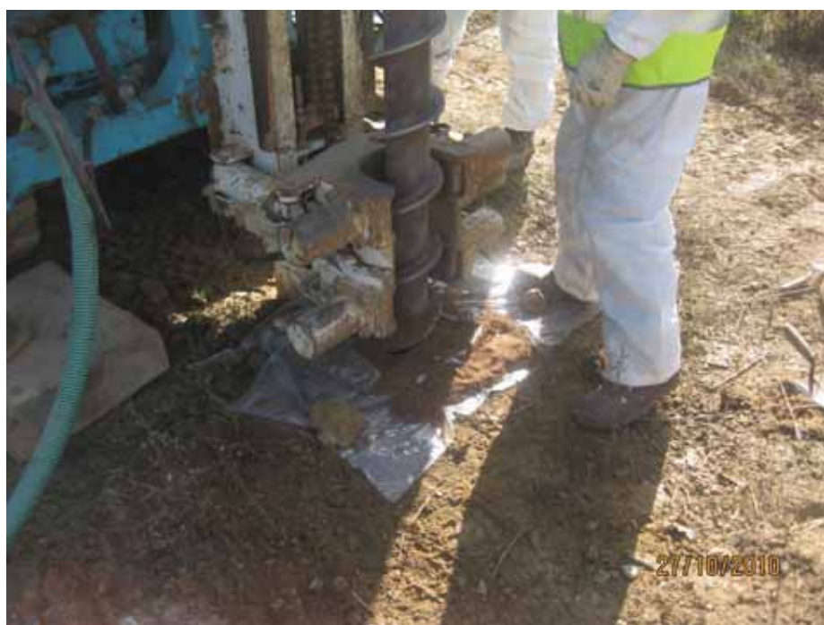
Figura 14 – Revestimento da área envolvente ao furo com película plástica
