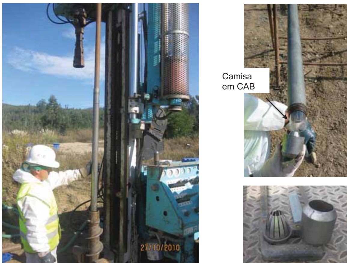
Figura 16 – Amostrador Macro-Core 300 a ser introduzido no trado oco (esquerda) e pormenores da ponteira (direita)
