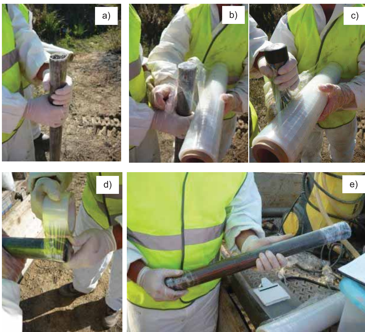
Figura 18 – Sequência das acções de selagem de uma amostra (extraída de [7])
