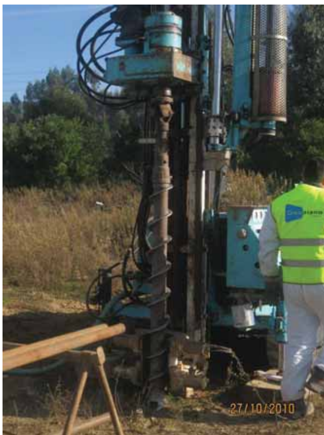
Figura 12 – Trado oco com \phi interno/externo (76/180 mm) e pormenor da secção transversal do trado
