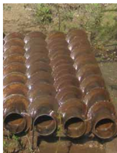
Figura 12 – Trado oco com \phi interno/externo (76/180 mm) e pormenor da secção transversal do trado
