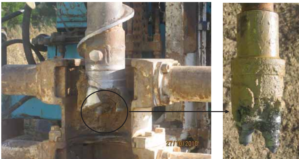
Figura 13 – Sonda de rotação ROLATEC 48L no interior do trado e pormenor da cabeça de rotação
