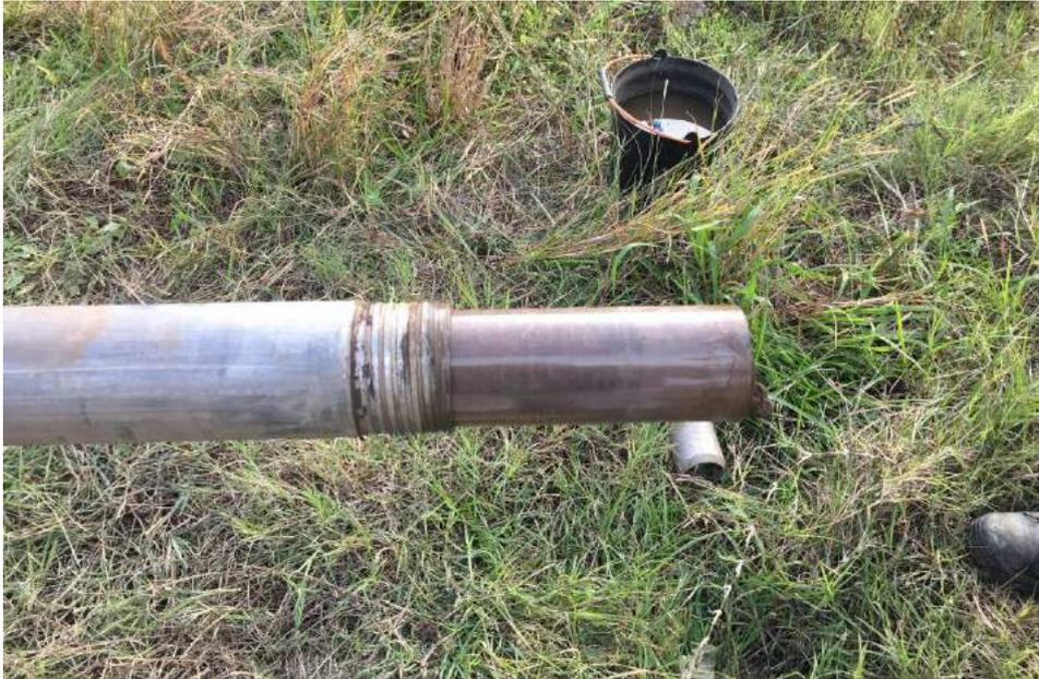
**Figura 3.12 – Extração da camisa em CAB do amostrador com uma amostra indeformada de resíduos**
