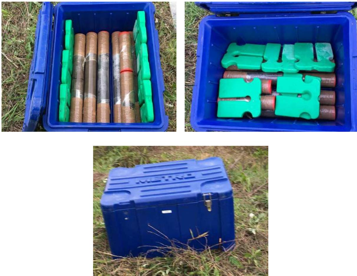
Figura 3.13 – Acondicionamento das amostras em arca térmica
