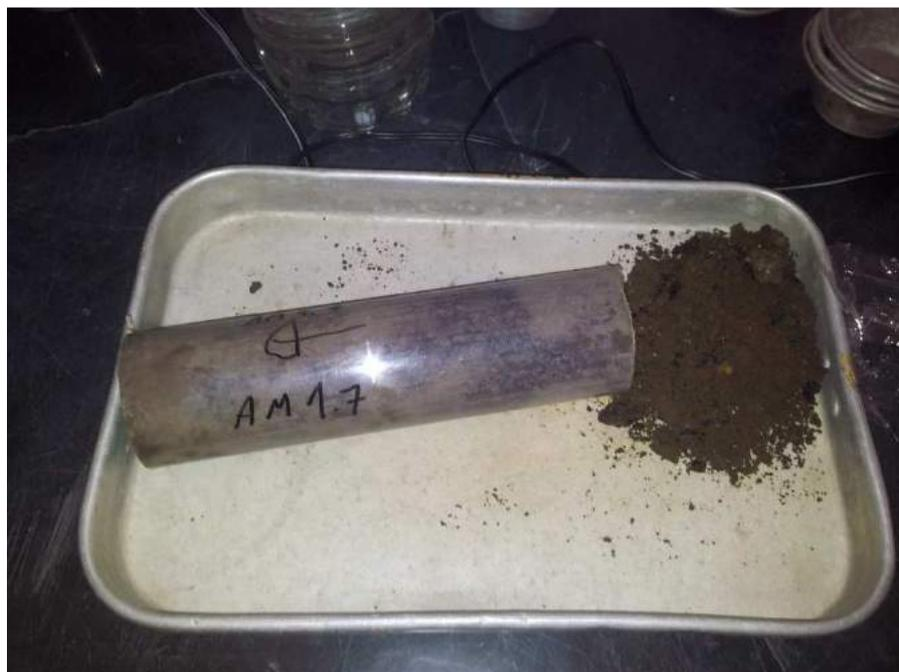
Figura 3.17 – Subamostra AM01.f utilizada nos ensaios de caracterização física dos resíduos
