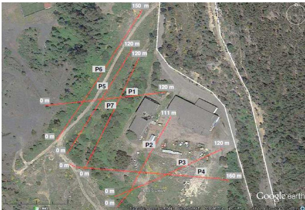
Figura 3.3 – Localização dos sete alinhamentos dos perfis de resistividade elétrica, com indicação das suas extensões (LNEC, 2017)
