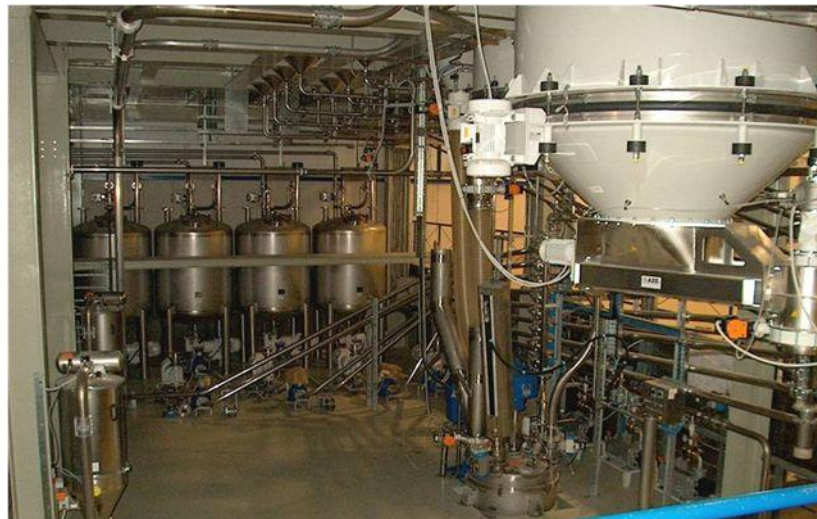
Figura 3-6 - Cozinha de pastas de PVC (exemplo de TMG Automotive 1).
