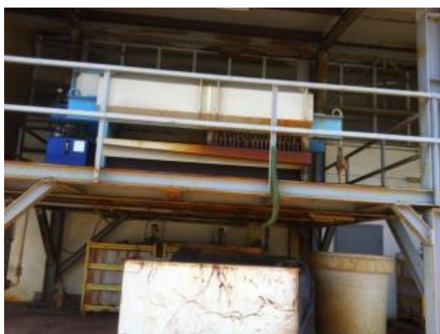
Figura 13 – Estação de regeneração do fluxante.
