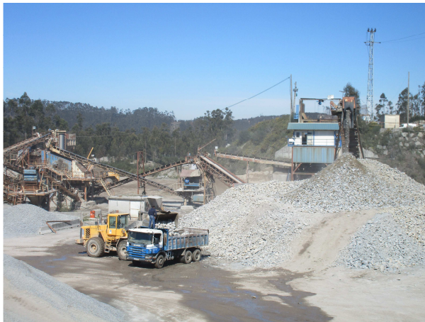
Fotografia 3.5 - Carga de material britado por uma pá carregadora frontal.
