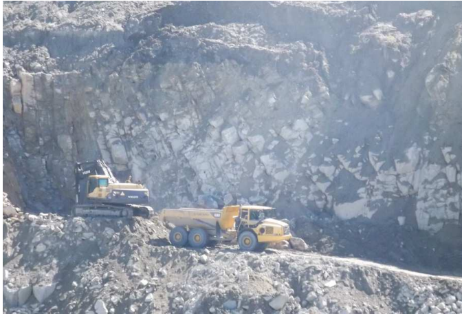
Fotografia 3.2 - Carga e transporte na frente do desmonte.
