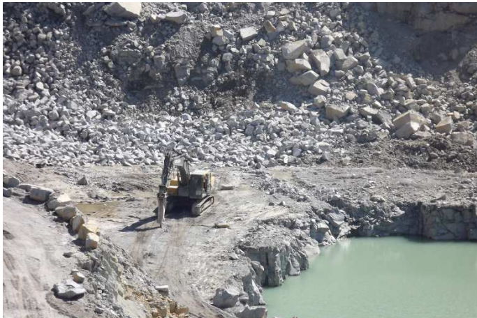
Fotografia 3.1 - Equipamento utilizado no taqueamento.
