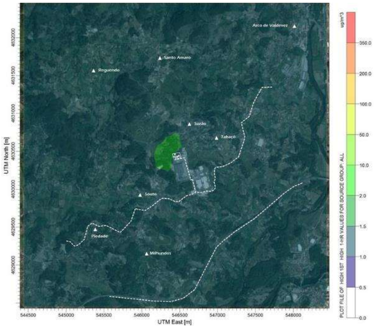
Figura 65 – Campo estimado das concentrações máximas das médias horárias de SO 2 (µg.m -3 ) verificadas no domínio em análise (Situação Actual).
