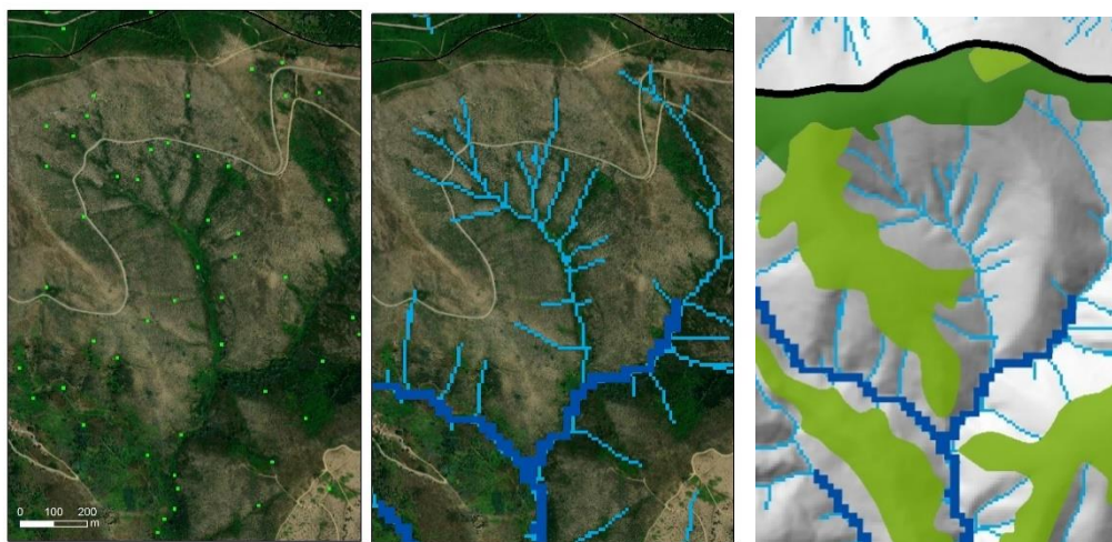
Figura 6 – Pontos de início das linhas de água, linhas de água gerada com bacia de drenagem com área 0,05 km 2 e cabeceiras das linhas de água (verde)
