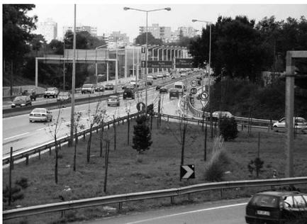
Figura 11 - Ilustração de acesso a via rápida praticamente sem via de aceleração
