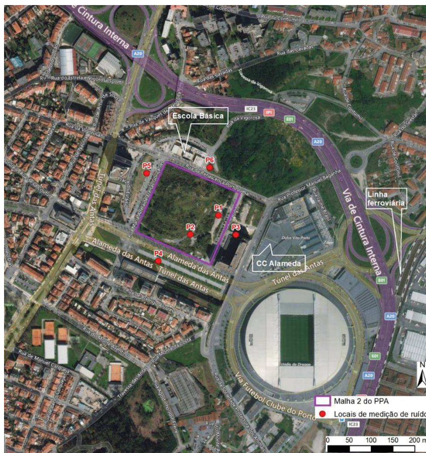
Figura 4.25 – Localização dos pontos de medição de ruído e Identificação dos recetores sensíveis mais próximos.
