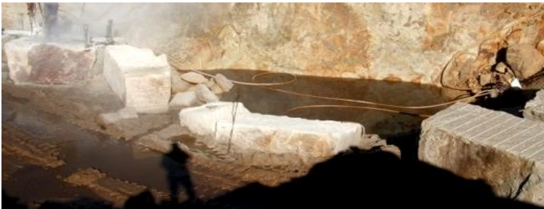
Figura 83: Represamento de águas de corte na frente de exploração para posterior utilização.
