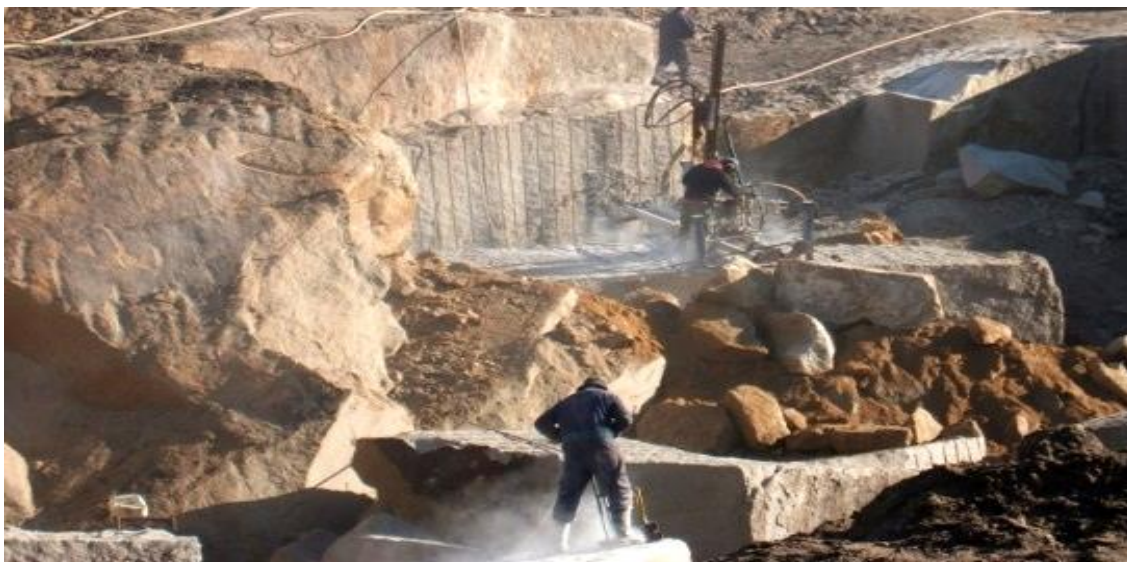
Figura 81: Execução de trabalhos de extração na frente de pedreira com emissão de poeiras e ruído.
