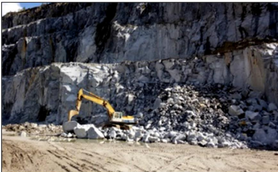
Figura 5: Vista da frente de desmonte (granito para inertes)
