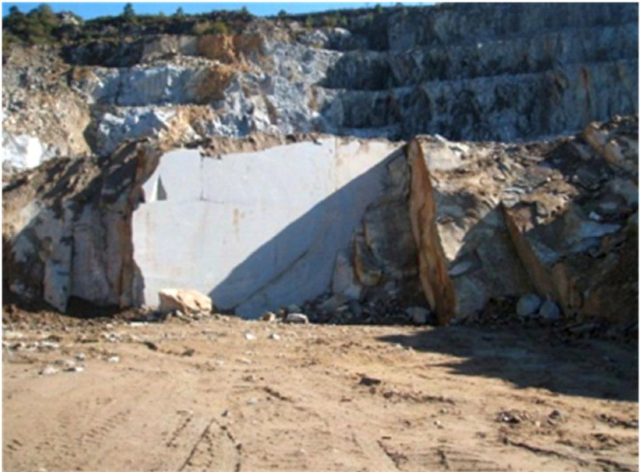
Figura 9: Frente de desmonte (granito ornamental)
