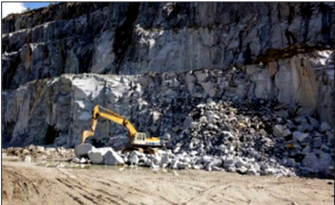
Figura 7: Vista da frente de desmonte (granito para inertes)
