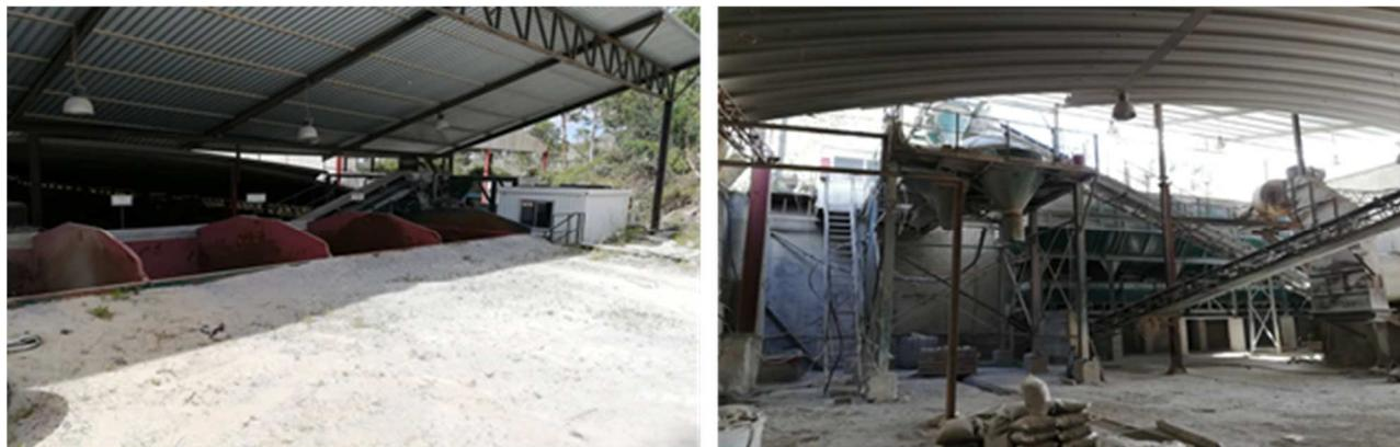
O processo produtivo consiste no envio dos agregados, por meio de tapetes rolantes doseadores, a 5 tolvas em linha com 18 m<sup>3</sup> de capacidade cada uma. A partir das tolvas, os agregados são enviados, por tapetes rolantes doseadores, a duas misturadoras onde são misturados com água, cimento e aditivos, dando origem ao betão pronto.
