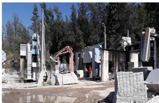
Nestas linhas de produção, procede-se ao corte/serragem dos blocos de granito obtidos nas frentes de desmonte, com cerca de 6,3 m<sup>3</sup> (2,80 m x 1,40 m x 1,60 m), transformando-os em “chapas” com espessuras predefinidas (1,5 cm, 2,0 cm ou 3,0 cm), por ação de máquinas de corte, munidas de discos de aço de elevada resistência diamantado (730 mm de diâmetro), com movimento de vai-vem e sistema de refrigeração dos discos por injeção de água.
