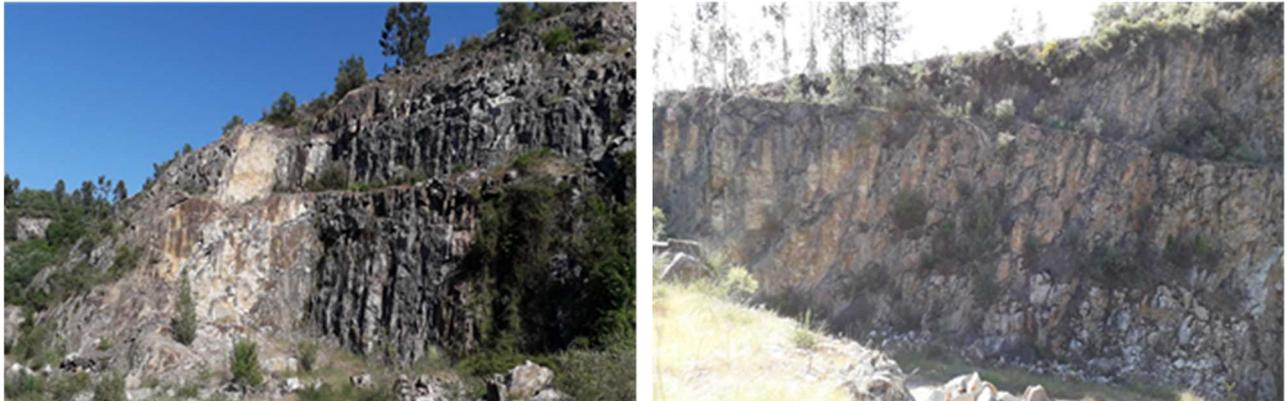
Neste setor, o desmonte de rocha é realizado por ação de explosivos introduzidos em furos subverticais realizados por uma máquina perfuradora, sobre lagartas, munida de um martelo hidráulico de coluna, com uma pressão de serviço da ordem dos 20 kg/cm<sup>2</sup> e uma velocidade de perfuração da ordem dos 60 m/h.
