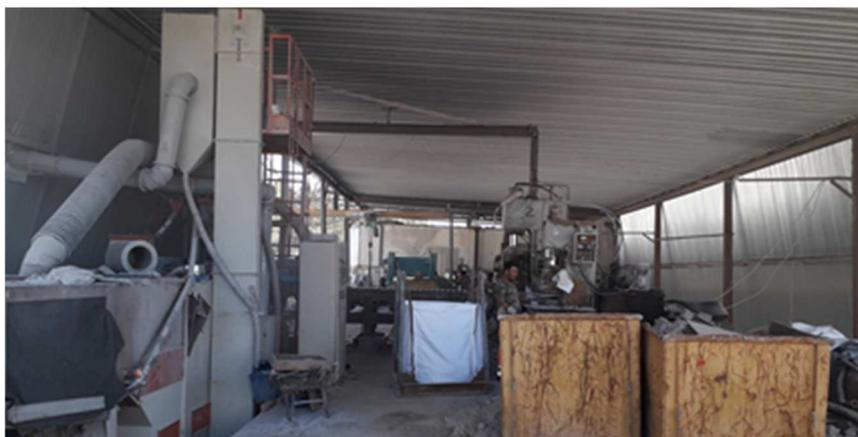
Os blocos de granito são previamente regularizados por meio de martelos pneumáticos, de modo a adquirirem uma forma paralelepípedica, podendo ficar num primeiro estágio quando se trata de produzir perpianho ou ser submetidos a sucessivas reduções de tamanho realizadas em máquinas de quebra de pedra até se obterem as dimensões pretendidas para os cubos de calçada.
