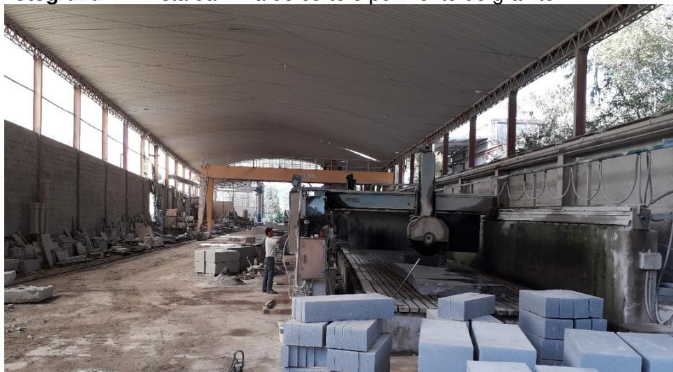
Situada próximo da instalação de corte e polimento, encontra-se uma instalação de quebra de granito para o fabrico de cubos de calçada ou de perpianho (pedra de construção), na qual se procede ao aproveitamento dos blocos de rocha de menor dimensão que são rejeitados, quer no processo anteriormente descrito, quer nas frentes de desmonte.
