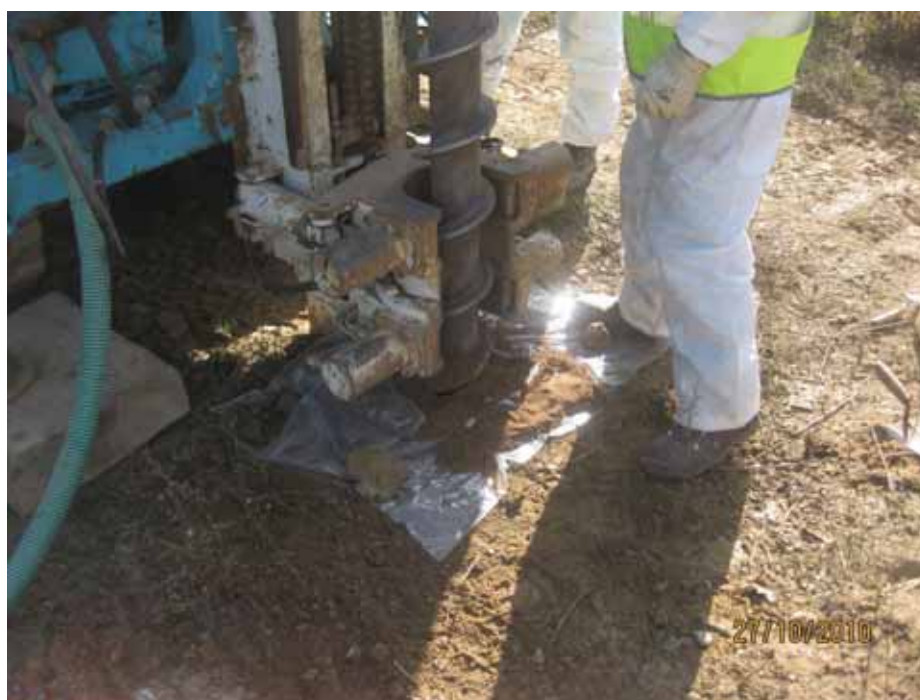
Figura 14 – Revestimento da área envolvente ao furo com película plástica
