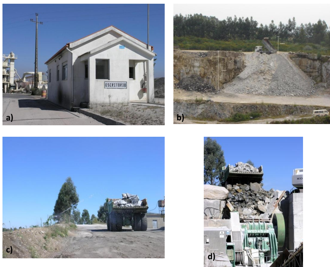
Figura 42. Instalações Bezerras - a) local de pesagem à entrada e à saída da instalação, b) armazenagem temporário dos resíduos, c) transporte por dumper para a central de britagem, d) colocação da pedra e resíduos na central de britagem
