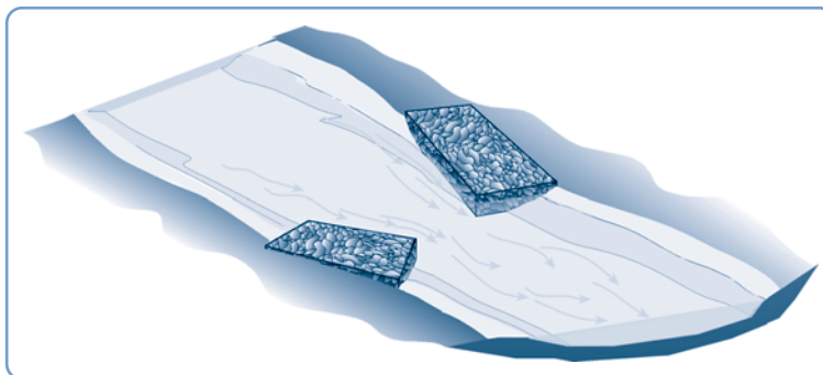
Figura 20 Deflectores limitadores de corrente
