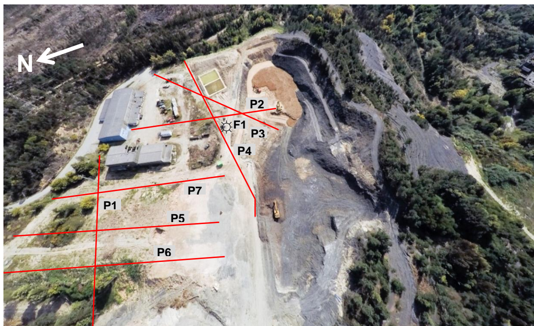
Figura 2.2 – Implantação aproximada dos alinhamentos (P1 a P7) e do piezómetro F1, sobre fotografia aérea, obtida em 2015 e disponibilizada pela CCDR-N
