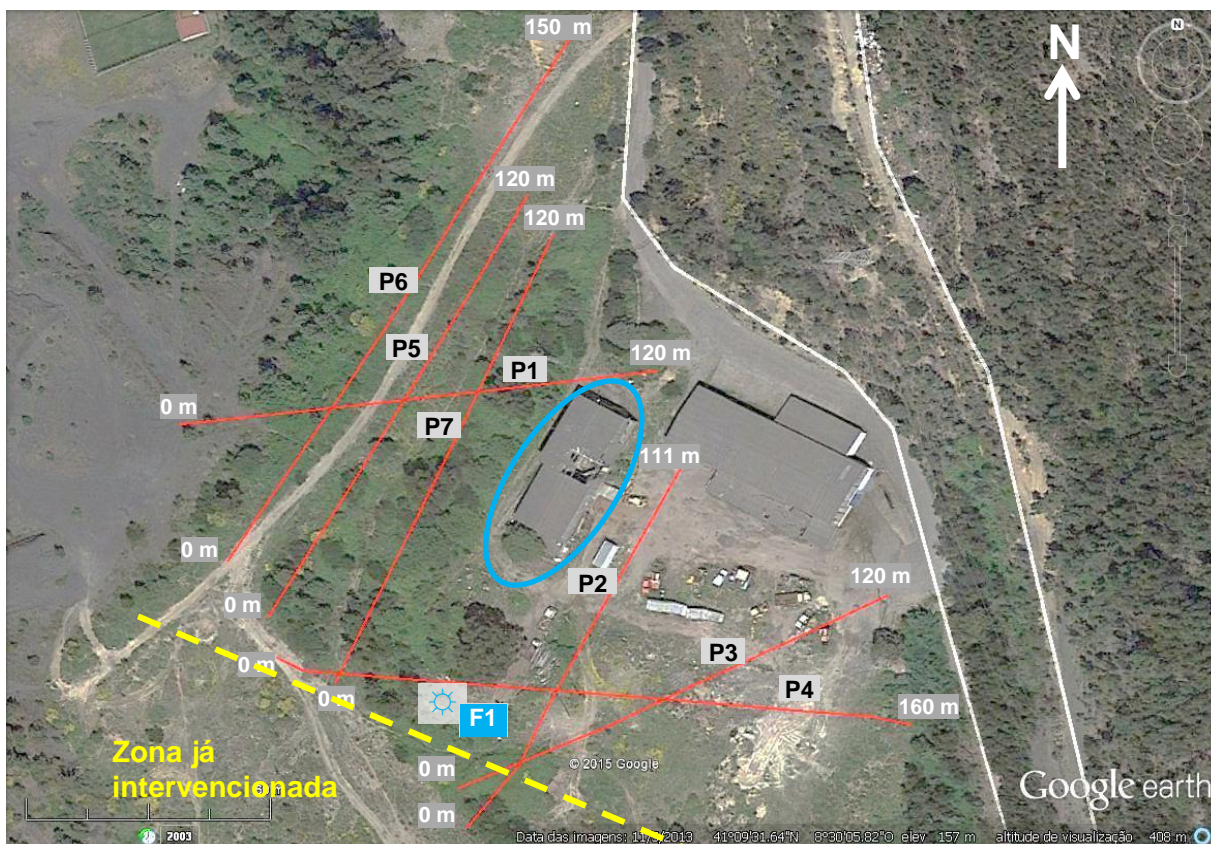
Figura 2.1 – Implantação dos perfis de resistividade elétrica, sobre imagem do Google earth de 2013/05/11, com identificação das respetivas extensões (linha a traço interrompido de cor amarela - limite aproximado entre a zona já intervencionada e a por intervencionar; elipse de cor azul – demarca edifício em ruínas; F1 – piezómetro)
